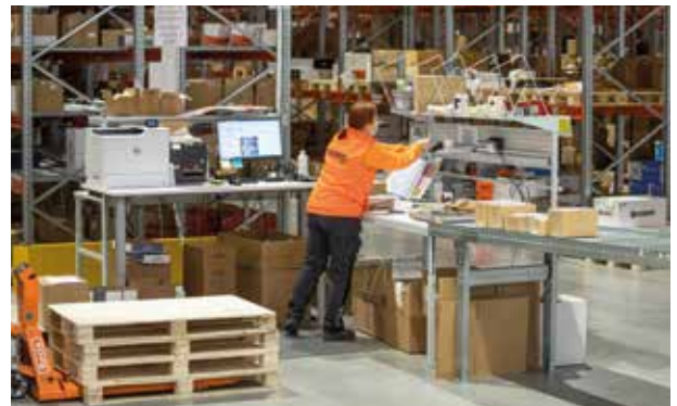
Kerätyt tilaukset jonoutuvat painovoimaiselle rullaradalle odottamaan käsitelyä. Pakkaustyöpisteessä kaikki tarvittava on käden ulottuvilla.
